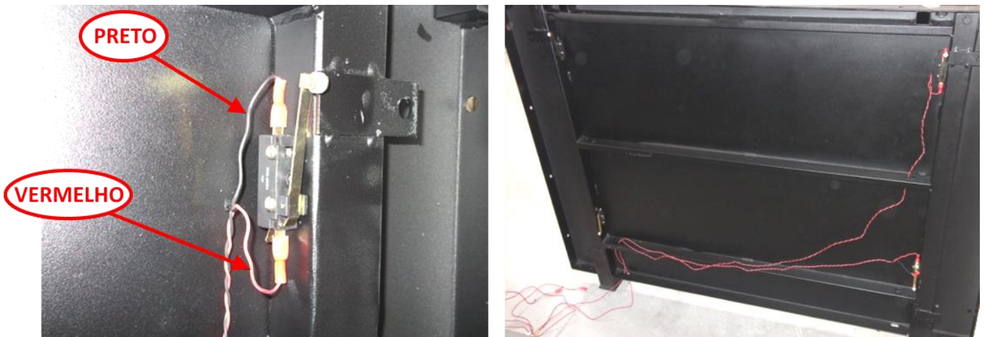
Figura 28: Fixação dos sensores do anti-esmagamento
