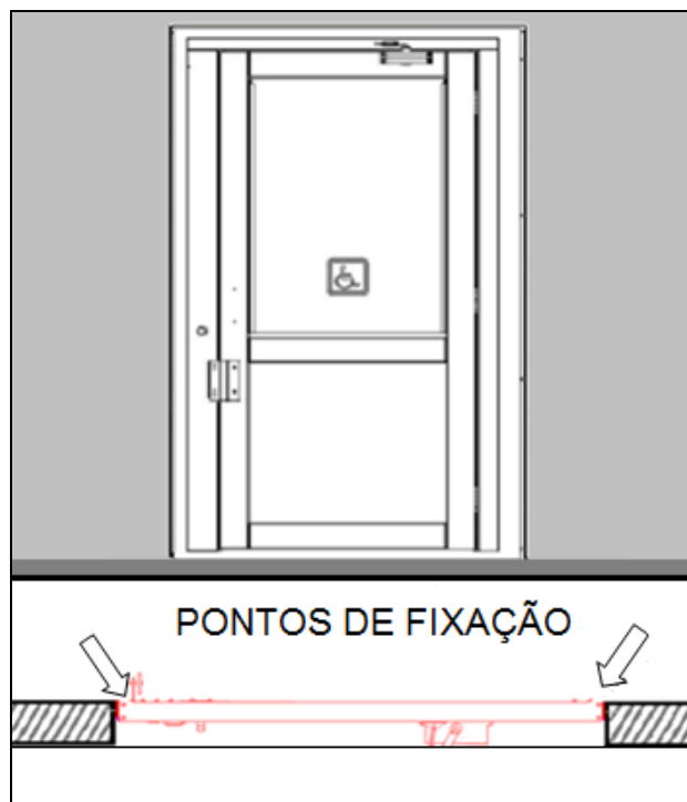
Figura 29: Pontos de fixação da porta no contra-marco
