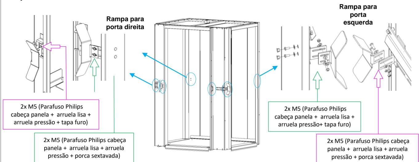
Importante: O posicionamento das Ramps irá depender da configuração de abertura das portas esquerda ou direita de cada pavimento!
