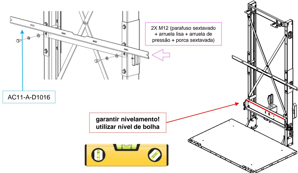
**Fixar chapas de fechamento do lado da botoeira (lado da torre) na travessa da arcada (A) e na base (B), fixar chapas entre si (C), kit 62943;**
