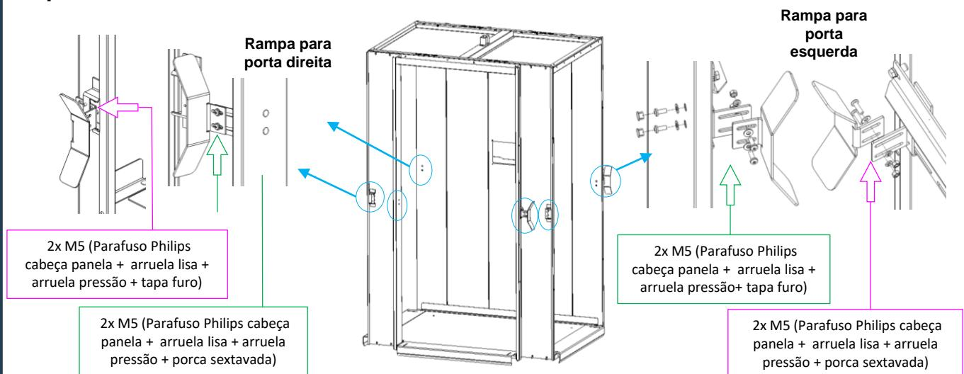
Importante: O posicionamento das Rampa irá depender da configuração de abertura das portas esquerda ou direita de cada pavimento!
