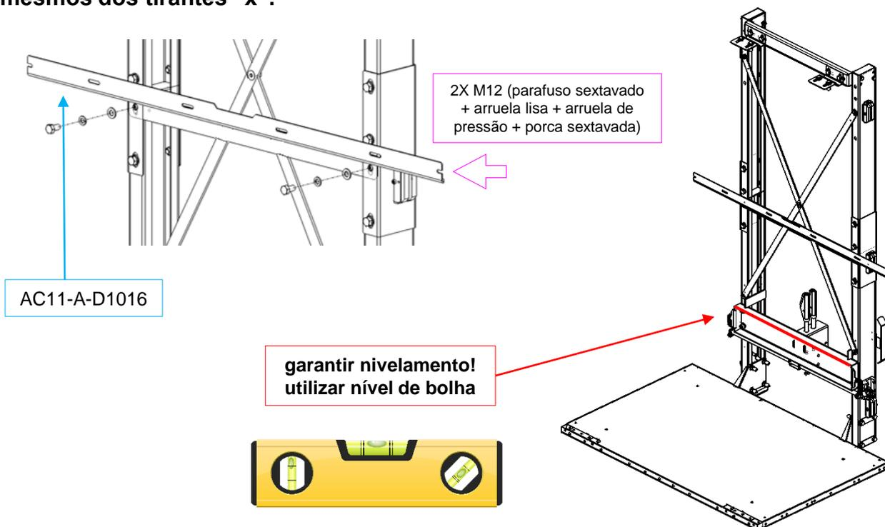
**Fixar chapas de fechamento do lado da botoeira (lado da torre) na travessa da arcada (A) e na base (B), fixar chapas entre si (C), kit 62943;**
