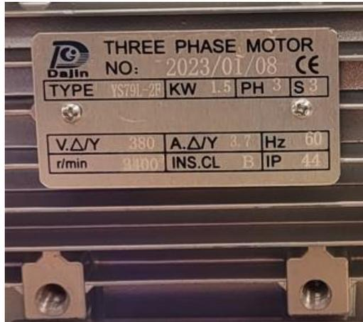
Figura 5: Placa de identificação do motor da Unidade Hidráulica
